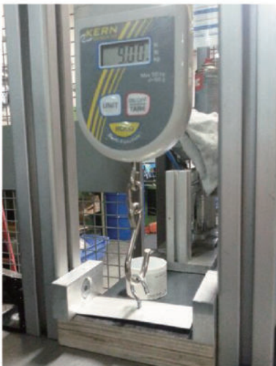
Glue pull tension force test 自粘胶拉力测试
